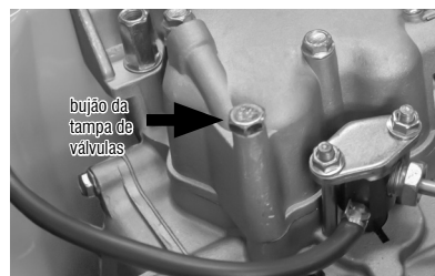
Fig. 12 – Bujão das válvulas
